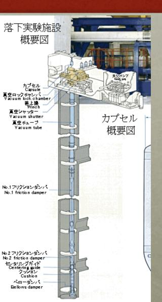
◆ MGLAB(岐阜県土岐市)の落下塔施設 →微小重力継続時間4.5s
